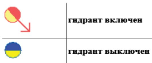
Условное обозначение водопроводного колодца с водоразборной колонкой в зависимости от режима работы:
