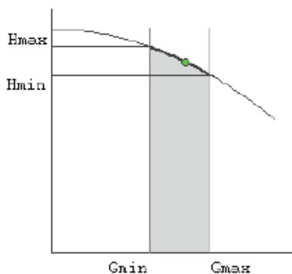
Задав хотя бы две точки, определяется парабола с максимумом на оси давлений, по которой расчет и будет определять напор насоса в зависимости от расхода. Следует отметить, что характеристика, задаваемая таким образом, может отличаться от реальной характеристики насоса, но в пределах рабочей области обе характеристики практически совпадают.
